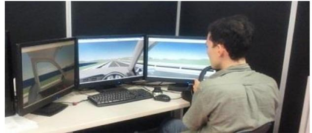
図5 簡易ドライビングシミュレータ
