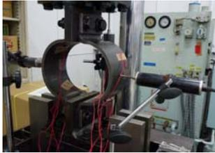
写真-1 疲労試験の実施状況
