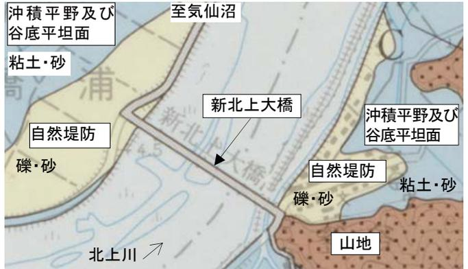
図-3 新北上大橋の地形分類図(原図<sup>4)</sup>に表層地質<sup>4)</sup>を加筆)
