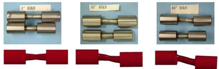
図-5 ローラーの変形形状の比較
