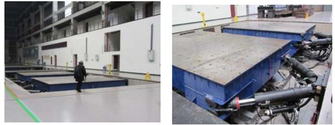
写真-1 マルチ振動台 (中国・同濟大学) (2012)
