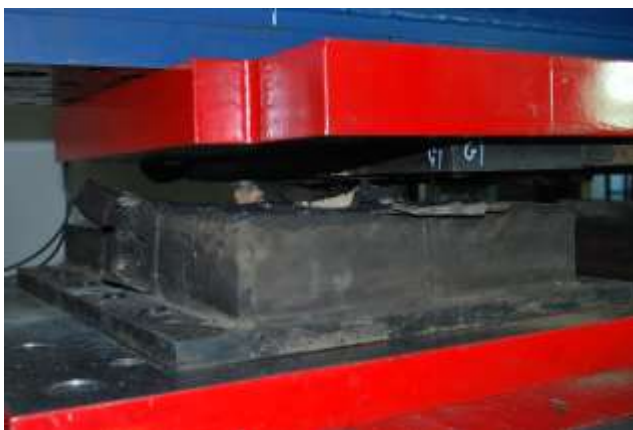
図2 劣化支承の破断
