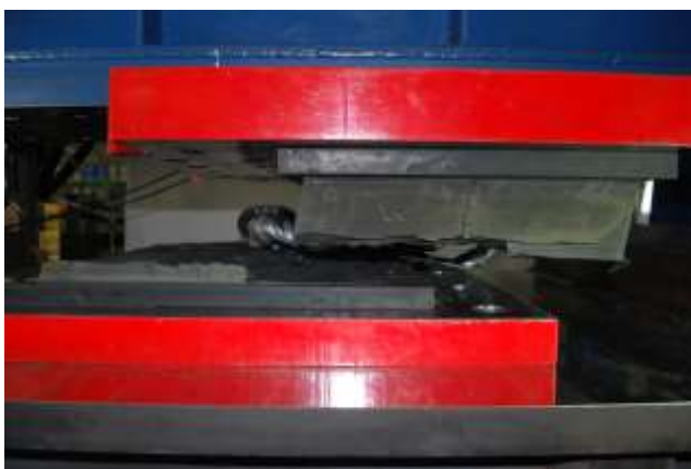
図3 リファレンス支承の破断
