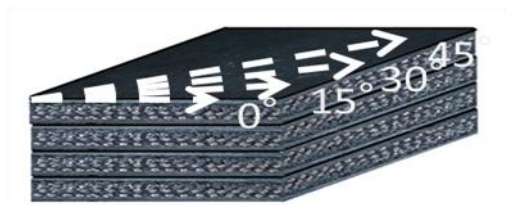
図-3 STRP-4 供試体と荷重方向
