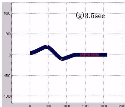
図-5 回転継手部及び伸縮継手部 弾性係数 1/10(20594N/mm<sup>2</sup>)
