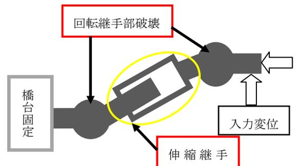
図-2 橋梁添架管路として応用した場合に予想される変位図
