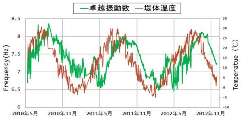
図-2 ダム卓越振動数と堤体温度の経時変動(mode-1)
