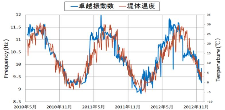
図-3 ダム卓越振動数と堤体温度の経時変動(mode-2)
