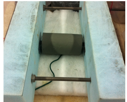
写真1 ベントナイト供試体のせん断波速度計測の様子（両側青い部分にベンダーエレメントが埋め込まれている）
