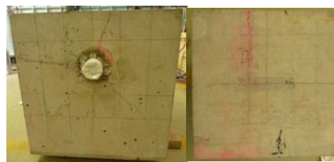
電食実験 (I-B供試体)
