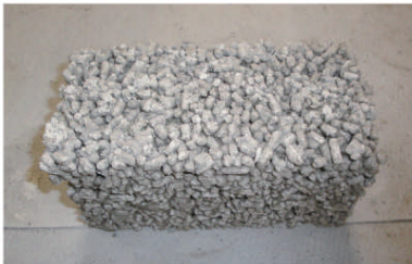
現地試験用に製作した人工ゼオライトブロック (セメント30wt%の造粒品を使用)
