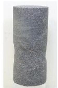
図-5 試験終了後の供試体写真(軸ひずみ 10%)
