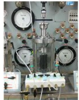
図-1 三軸試験機(CD 試験)
