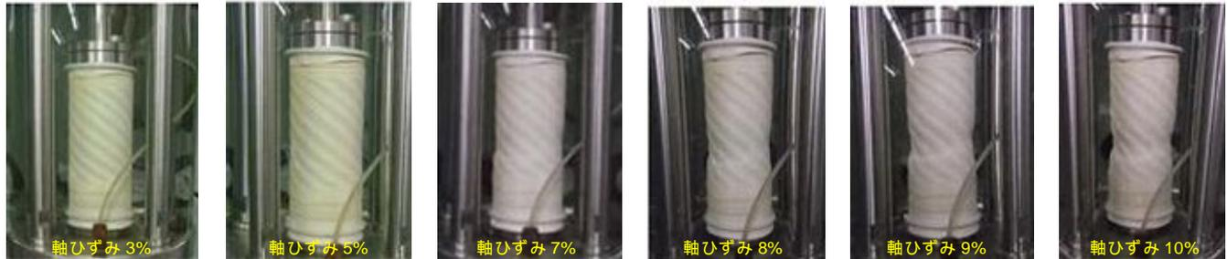
図-2 軸ひずみの変化と供試体の変形状況
