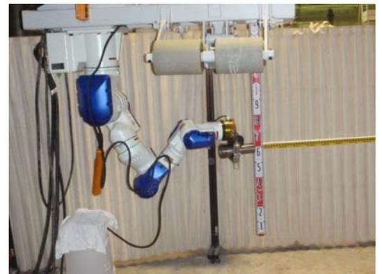
図-2 吹付けロボット
