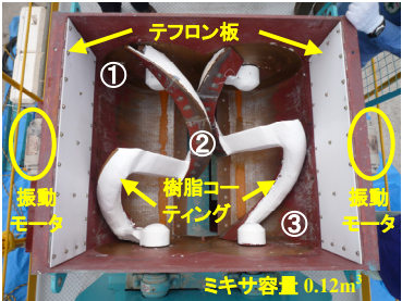
図-1 付着低減対策と試料採取位置
