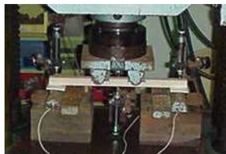
写真1 曲げ載荷状況
