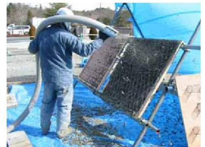
写真-1 試験体の製作状態
