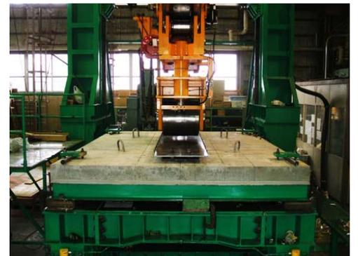
図-2 輪荷重走行試験機
