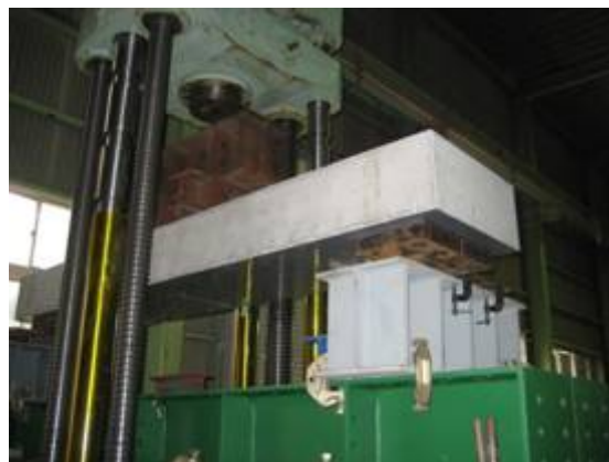
写真 1 供試体 A1t 設置状況
