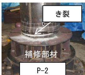
図 8 補修部材直上のき裂
