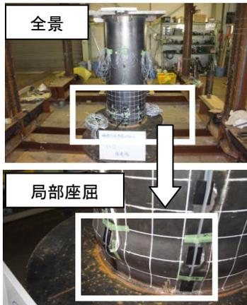
図 1 損傷した部材
