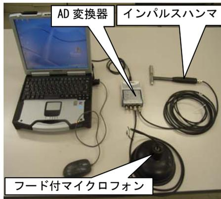
写真-4 打音検査装置
