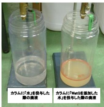
写真-2 油汚染試料からの廃液の比較
