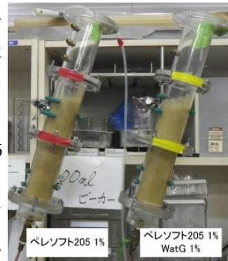
写真-3 初期状態 (装置設定角度 17°)
