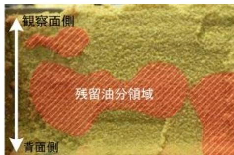
写真-1 土槽内部における浄化ムラ
