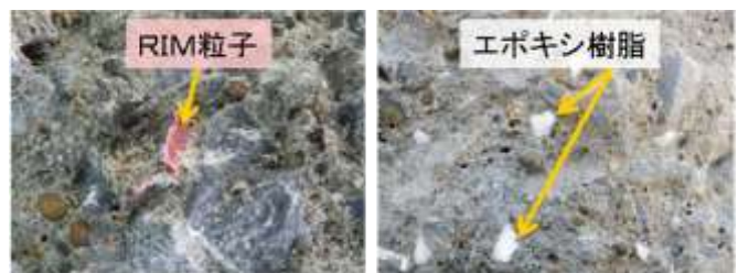
図－７ 引張試験割裂断面状況
