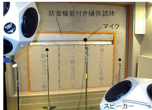
図-5 音響透過損失試験状況(送音側)
