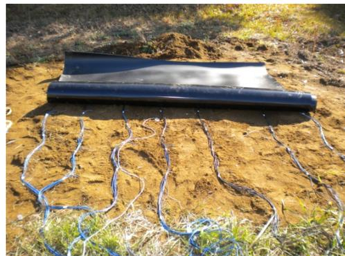
写真-2 測定電極設置状況(地盤)
