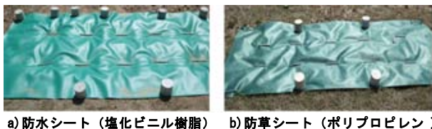
写真2 漏水時間の検証状況写真
