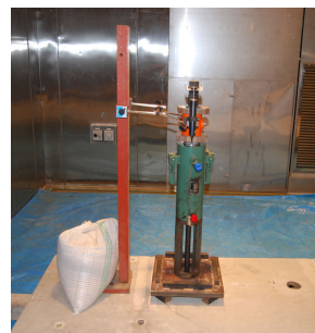
図 5 引抜試験状況
