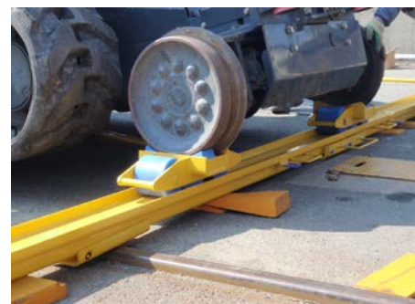
写真-4 カンザシレール
