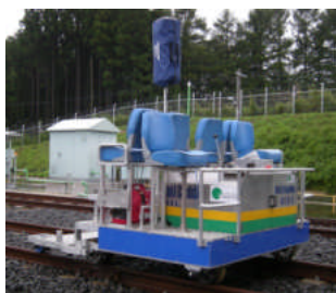
図一6: 完成車両(レールキャディー)
