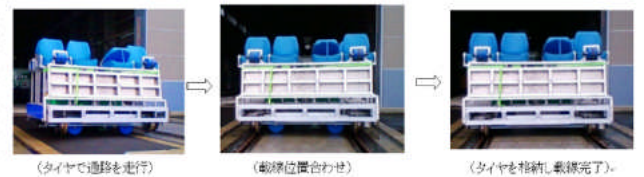
図四: 構内通路での載線の様子
