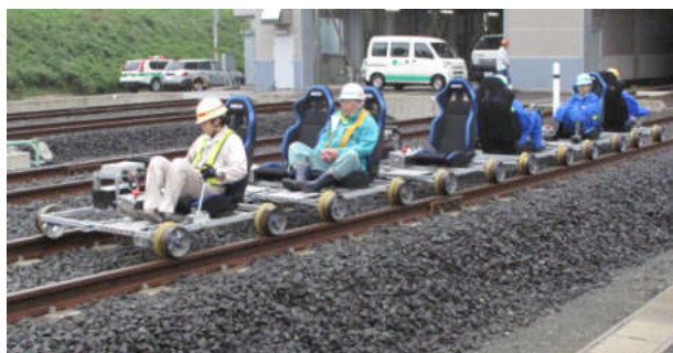
図一9: 基地線内での走行試験の様子
