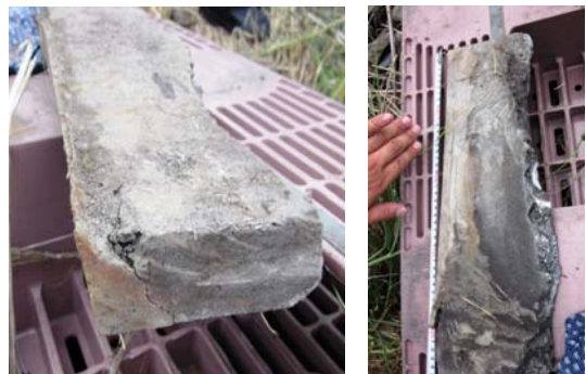
図-9 樹脂モルタルを含む部分の切断箇所
