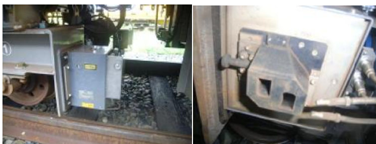
(b) レール凹凸センサ測定部 (c) レーザー照射部 図-1 レール凹凸測定器概要
