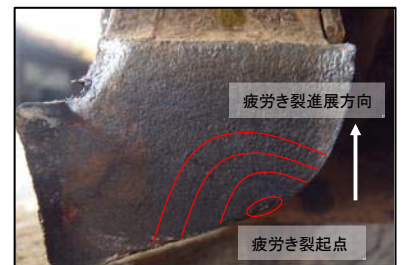
図 1 折損継目板の破断面
