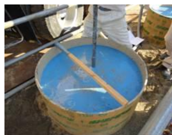
図-6 泥水巻き込み確認試験
