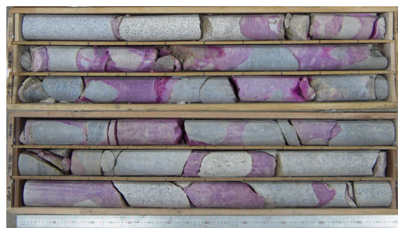
写真1 コア採取での充填状況（一部）
