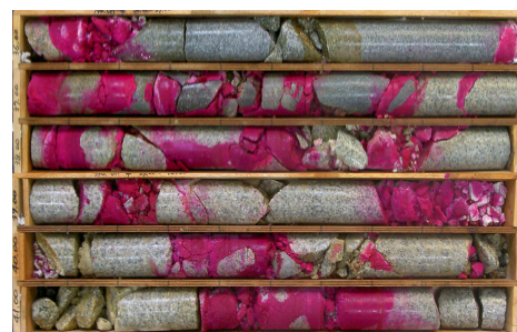
写真2 コア採取での充填状況(一部)
