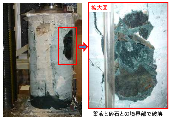
写真-1 大型一軸圧縮試験 破壊状況 (ケース 懸濁型薬液)
