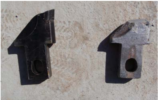
写真－2 ビット摩耗状況
