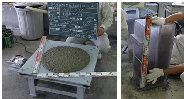
写真-1 加振動変形およびU形充填性試験
