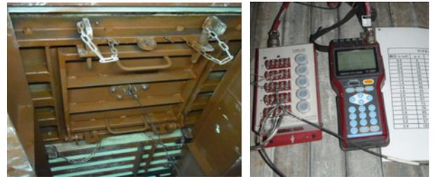
写真-2 コンクリート側圧計測
