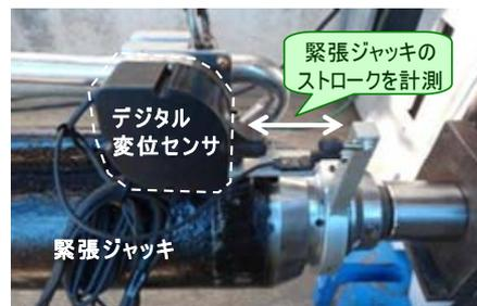
図-3 伸びの自動計測
