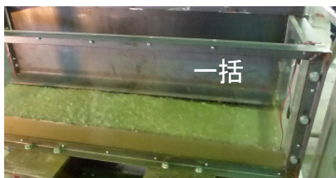
写真1 コンクリートの充てん状況 (4分経過後)
