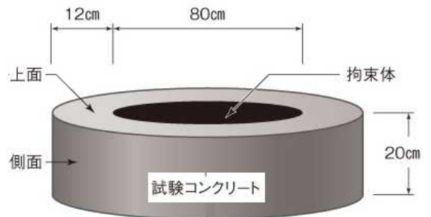
図1 拘束試験体の概要
