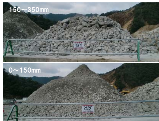
写真-2 粒度管理した解体ガラ
