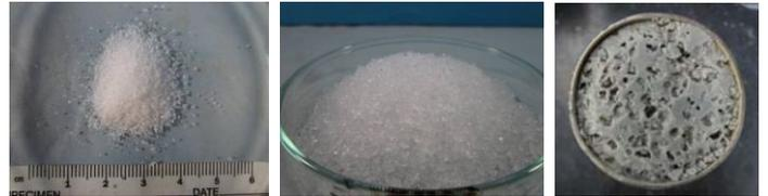
写真-1 吸水ポリマー (吸水前) 写真-2 吸水ポリマー (吸水後) 写真-3 空隙状況
