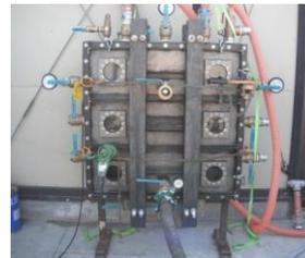
写真-4 打設試験用型枠
