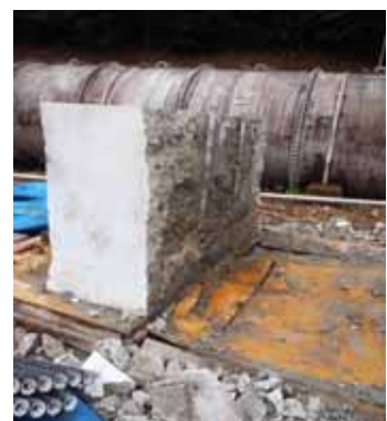
写真－5 分割されたRC試験体
