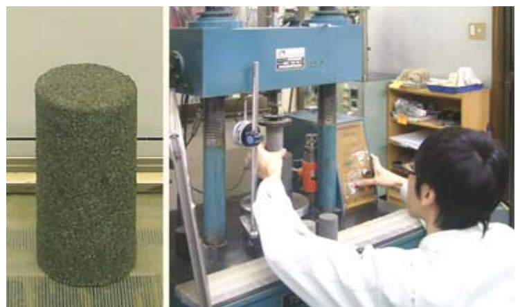
図-3 効果確認試験の状況（一軸圧縮試験）
