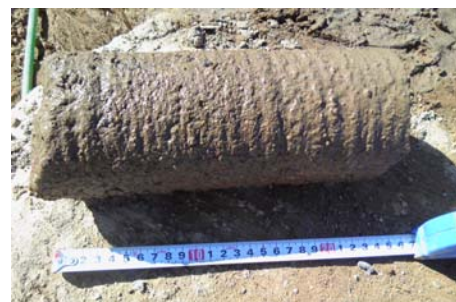
図-2 コアドリルによるサンプリング(鉛直方向)
