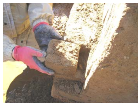
図-3 ブロックサンプリング(水平方向)
