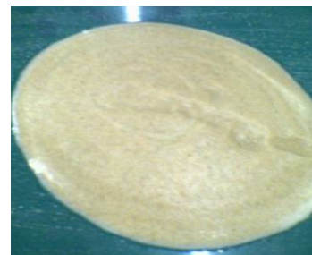
写真-2 気泡混合土
