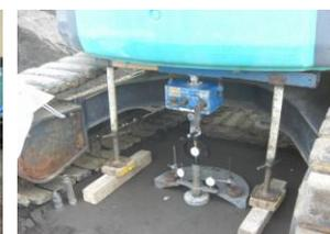
図-4 路床造成状況 図-5 現場 CBR 試験状況
