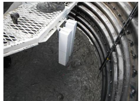
写真-3 水位検出センサ (レーザー変位計)
