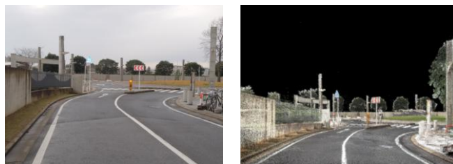
図—1 走行場所例（左：写真、右：点群データ）
