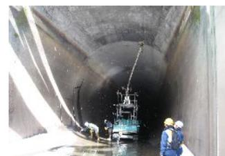
図-1 空洞レーダー探査
